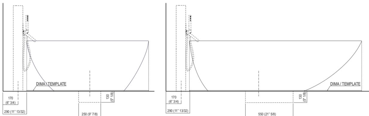
Per un corretto posizionamento del pozzetto e della rubinetteria è necessario utilizzare la dima in cartone con sagoma uguale al profilo superiore della vasca.
